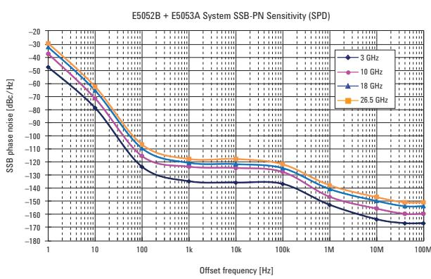
Figure 10-2. System phase noise sensitivity (E5053A + E5052B) (SPD)
